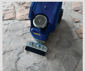
Drehbare Klingenhaltung damit die Klinge immer flach am Boden aufliegt- auch bei unebenen Unterböden.
