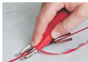
Nachschnitt mit ausgeschwenkter Distanzgabel
