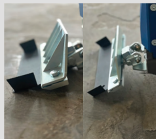
Flexible Winkeleinstellung der Klinge für weichere oder härtere Untergründe.
