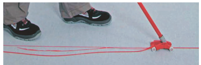
Speed Trimmer MOZART - in stehender Arbeitshaltung kann in einem Arbeitsgang sowohl der Vor- als auch der Nachschnitt der erkalteten PVC Schweisssschnur gemacht werden.
