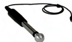
Kugelsonde zum zerstörungsfreien Aufspüren von Baufeuchte
