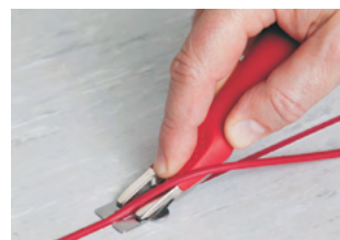
Abstoßmesser MOZART Vorschnitt mit eingeschwenkter Distanzgabel
