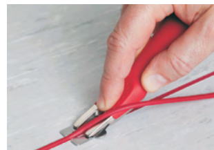
Abstoßmesser MOZART Vorschnitt mit eingeschwenkter Distanzgabel
