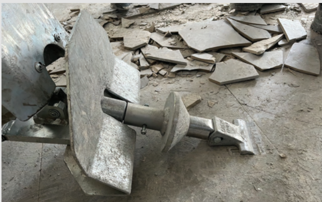
Abbildung zeigt Keramik-Meißel 100 x 150 mm mit Werkzeughalter in Kombination mit Messerschaftverlängerung mit Kegelabweiser.
