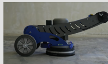
Transportposition mit nur 480 mm Höhe
