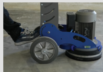
Mit Fussraste zum einfachen Kippen der Maschine
