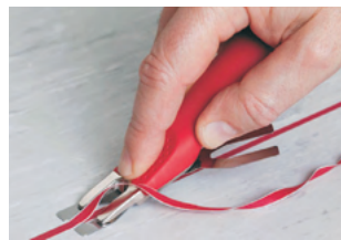
Nachschnitt mit ausgeschwenkter Distanzgabel
