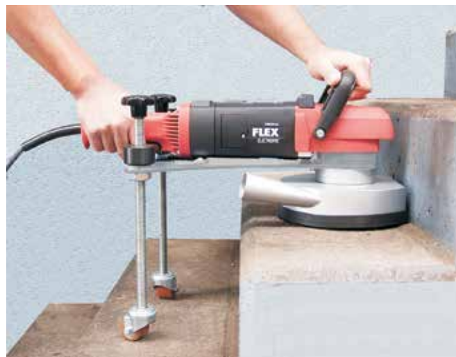
HF 180 Caddy beim Einsatz auf Treppenstufen
