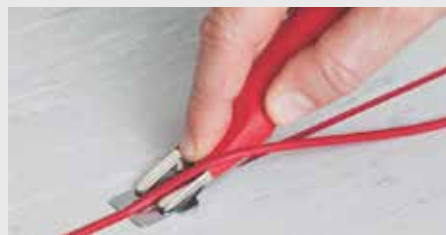
Vorschnitt mit eingeschwenkter Distanzgabel
