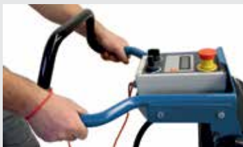
Totmannschalter für sicheres Arbeiten
