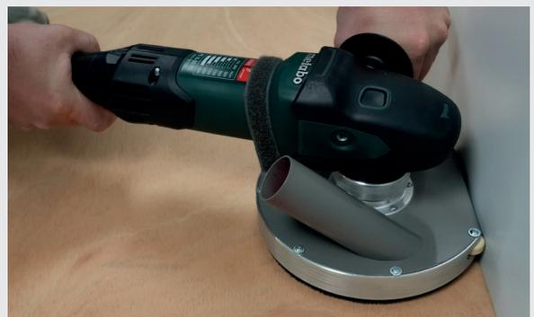
Die frei drehbare Absaughaube ermöglicht eine bestmögliche Absaugung und geniale Bewegungsfreiheit beim Randschleifen.
