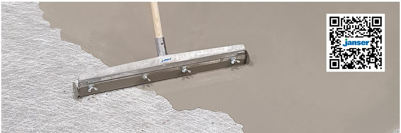
Die seitlichen Rollen gleiten über die Fasern und ermöglichen so ein gleichmäßiges Verteilen und Nivellieren der Ausgleichsmasse und den Fasern. Die Auftragshöhe von 3 - 17 mm lässt sich einfach über die Höhenschiene mit Skala einstellen.
