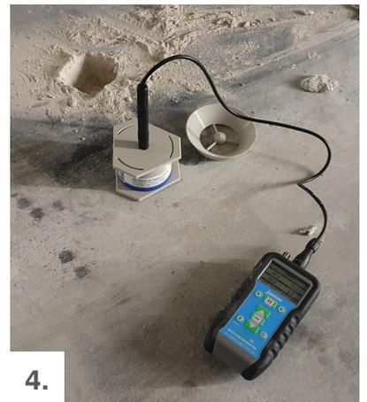
**Wenn sich der Messwert stabilisiert hat und nicht mehr verändert (nach ca 15- 30 Min.) zeigt das Gerät ein aussagefähiges Messergebnis zur Feststellung der Belegreife an. Ausführlich beschrieben im TKB-Merkblatt 18.**
